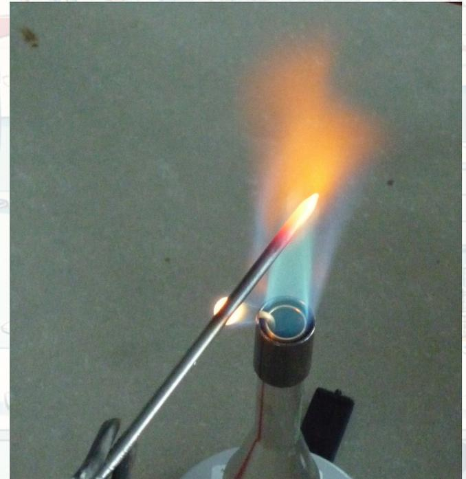
Heiße Körper senden Strahlung aus, wie z.B. dieser glühende Eisennagel.
